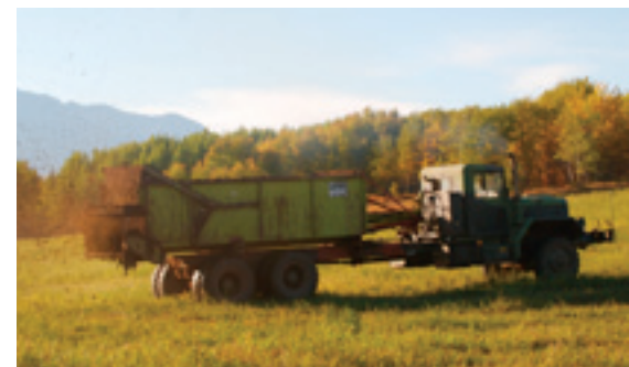
Un camion militaire 6 X 6 modifié de cinq tonnes, doté d'un épandeur à fumier Loewen, attaque les côtes même en conditions pluvieuses.
